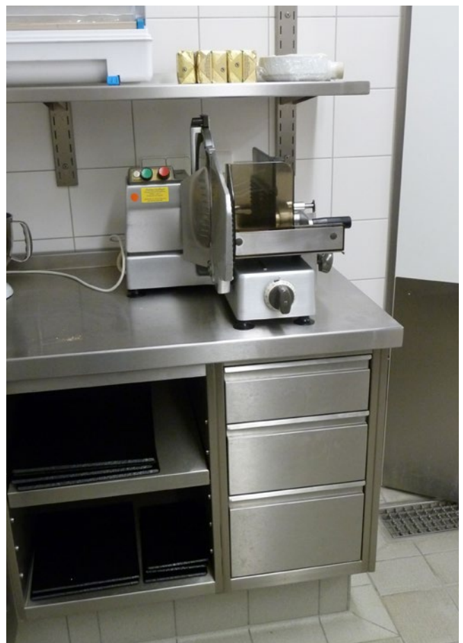
Abb. 8 Geeignete Aufstellung der Aufschnittschneidemaschine
